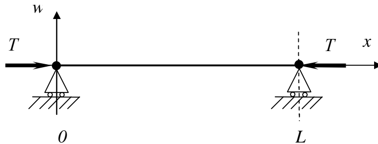
Рис. 1.1. Сжатый шарнирно опертый стержень.
