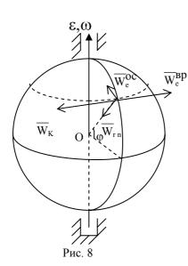
Ускорение точки M находим по формуле (3.4). Ускорение относительного движения зададим в проекциях на оси естественного трехгранника. При этом  $W_{r\tau}=0$ , относительное движение равномерное, а  $W_{rn} = V_r^2 / \rho_r = V^2 / R$ (здесь  $\rho_{"}$  - радиус кривизны траектории точки М в относительном
