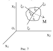
принятой неподвижную, то такое движение называется движением сложным точки. Свяжем подвижной средой систему отсчета  $O\xi_1\xi_2\xi_3$ , неподвижной средой систему отсчета  $O_1 x_1 x_2 x_3$ . Движение точки М относительно подвижной
