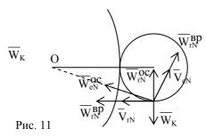
Так как относительное движение тела чисто вращательное, то касательная составляющая  $\overline{W}_{r\tau}$  ускорения совпадает с вращательной
