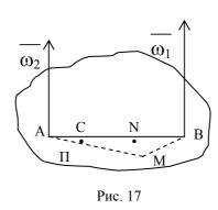
$\omega_2 AC = \omega_1 BC$ , откуда  $AC/BC = \omega_1/\omega_2$ . Для произвольной точки М плоской фигуры, учитывая,
