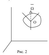
Компоненты ускорения  $\overline{W}^{\it ep}=\overline{\mathcal{E}}\times \rho_{\it i}$  и  $\overline{W}^{\it oc}=\overline{\omega}\times\overline{\omega}\times\overline{\rho}_{\it i}$  соответственно называются вращательным
