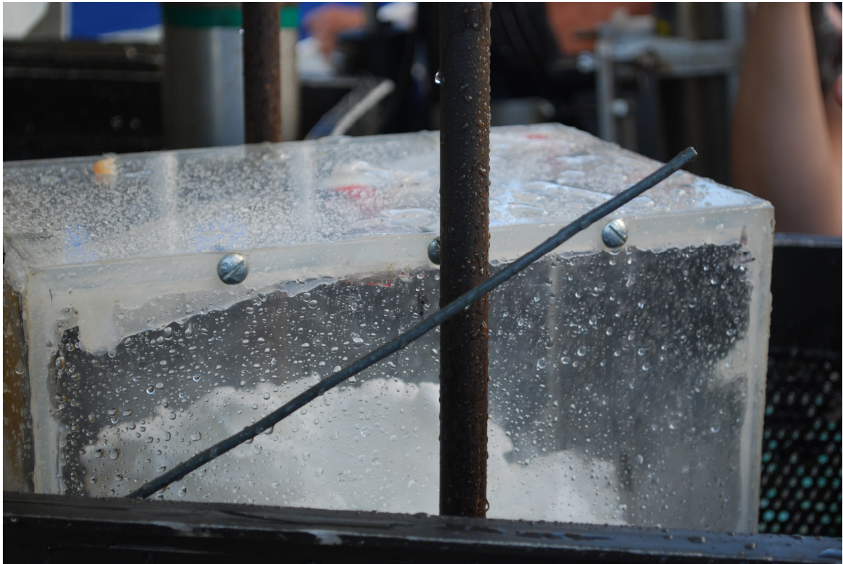
Рис. 10. Контейнер «Телевизор» с метановым гидратом внутри поднят на поверхность.
