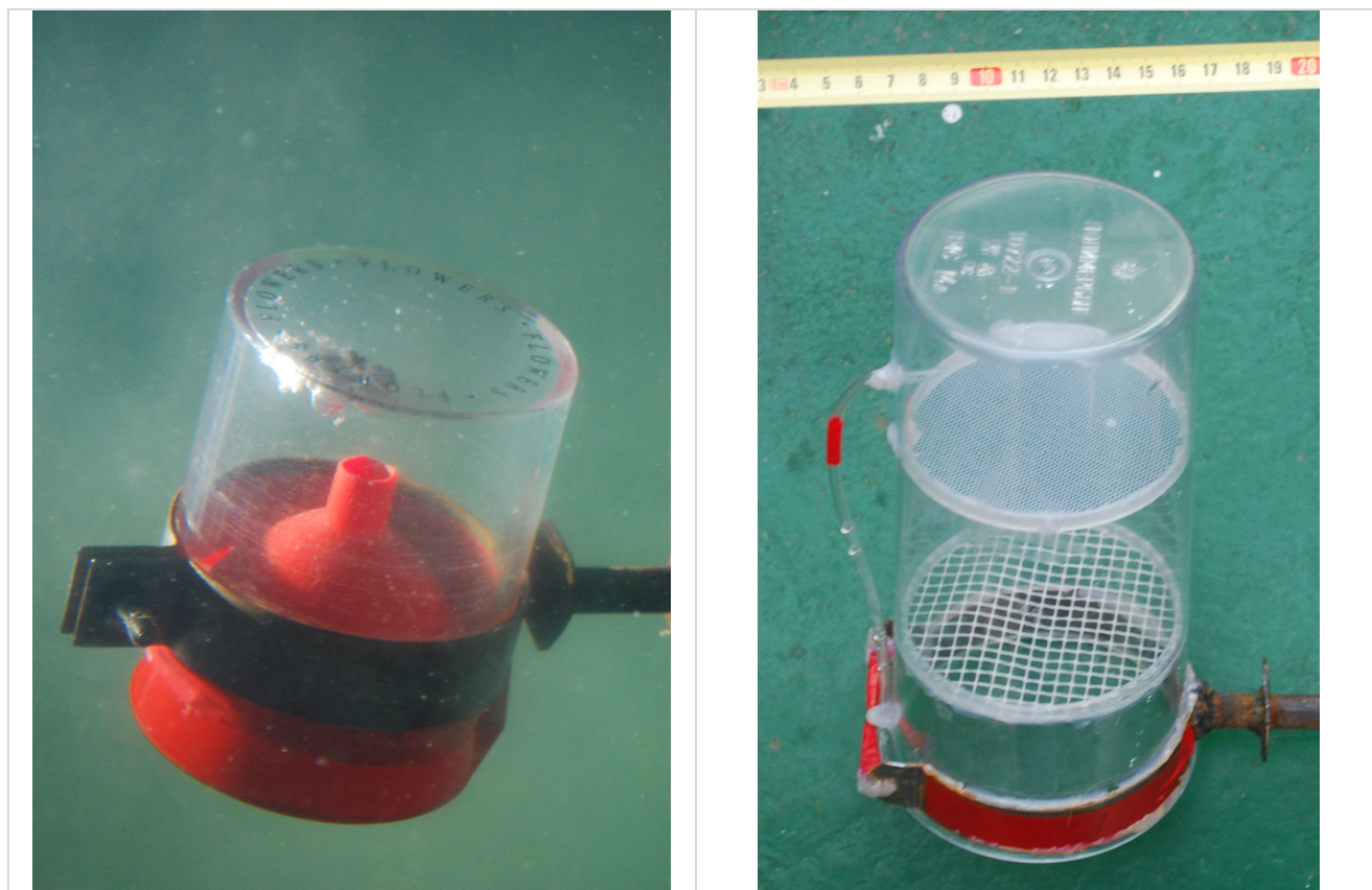
Рис. 3. Ловушка «Воронка» (диаметр стакана 85 мм) и вариант ловушки «Сетка-2» (диаметр стакана 101 мм, размеры ячеек сетки 1 и 6 мм).
