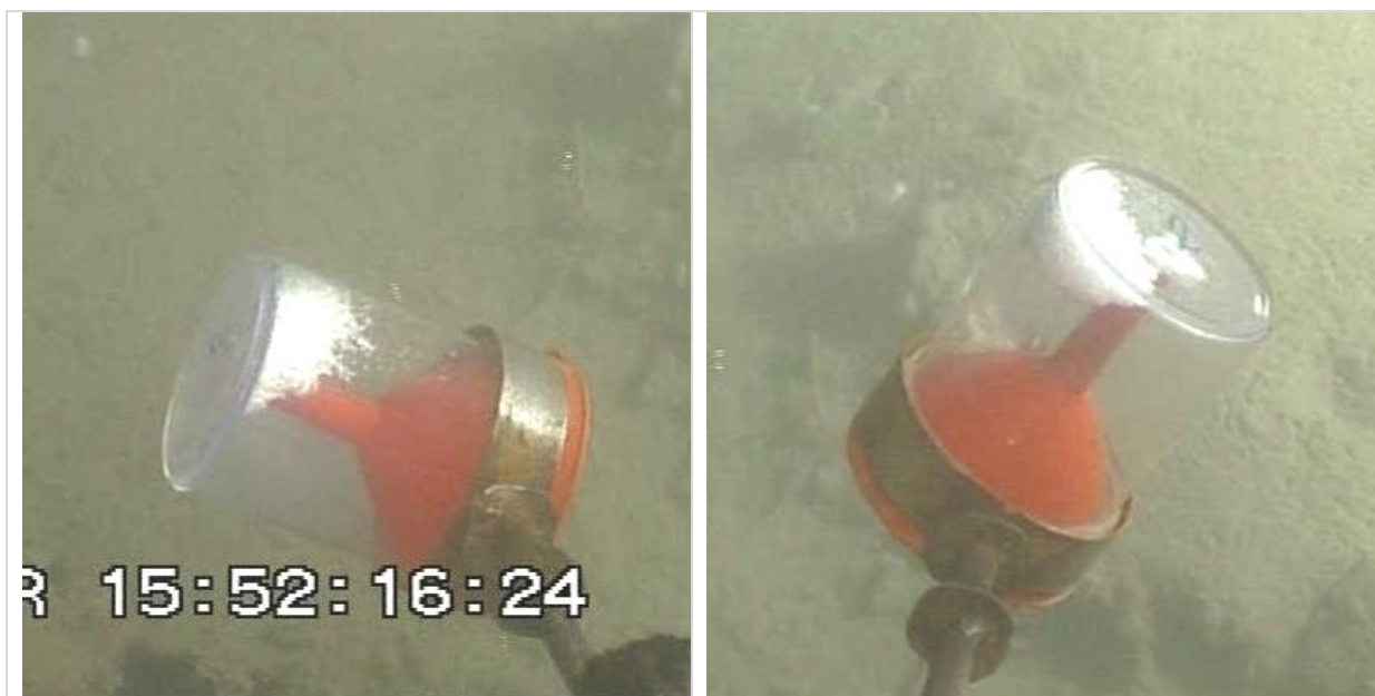
Рис. 10. При покачивании ловушки «Воронка» гидратная сыпучая среда свободно пересыпается из одного края в другой.
