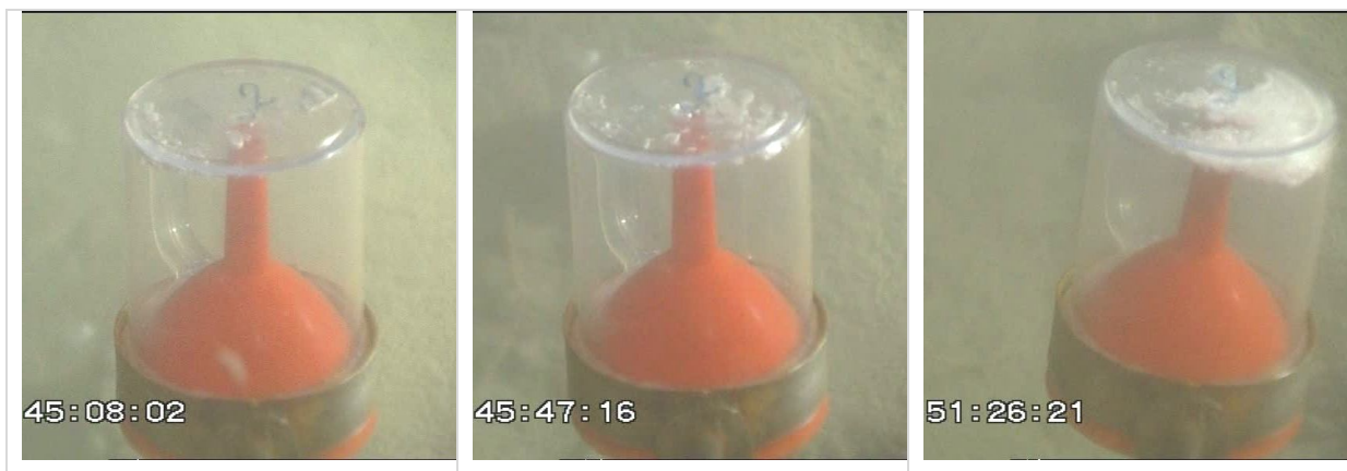
Рис. 9. Поступавшие в ловушку «Воронка» пузыри метана постепенно формировались в гидратную сыпучую среду – гидратный порошок. Тайм-код на фотографиях представляет мин : сек : сек100.
