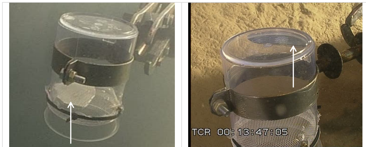
Рис. 4. Сбор газа в ловушку «Сетка-1» на глубине 405 метра. Сначала единый пузырь (отмечен стрелкой) формируется под сеткой с ячейкой 1 мм (левая фотография), затем при встряхивании ловушки пузырь перетекает сквозь сетку в верхнюю часть ловушки (правая фотография).
