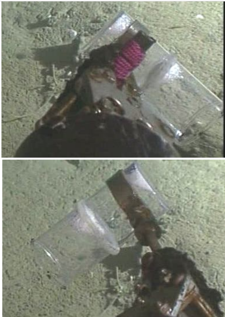
Рис. 8. Качание ловушки вокруг оси манипулятора вызывало пересыпание гидратной сыпучей среды в верхние части отсеков ловушки.
