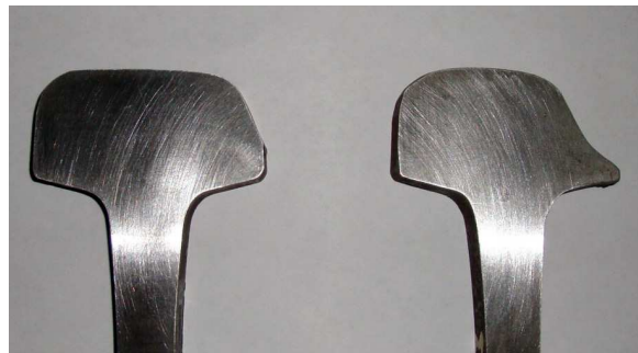
Рис. 2.50. Поперечное сечение бывшего в эксплуатации рельса
