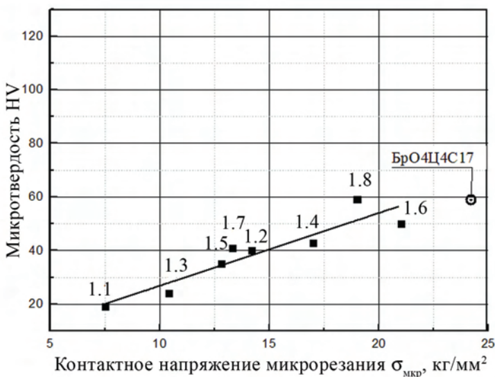
Рис. 3.7. Корреляция между микротвердостью и контактным напряжением микрорезания (1.1 – 1.8 – номера исследуемых образцов)
