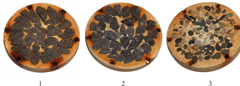
Рис. 1.21. Модельные образцы дорожной поверхности: 1 — крупные камни с шероховатой поверхностью, 2 — крупные камни с гладкой поверхностью, 3 — маленькие камни с гладкой поверхностью
