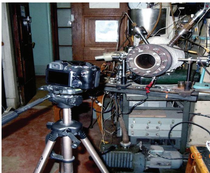
Рис. 2. Расположение скоростной видеокамеры для съемки процесса горения.
