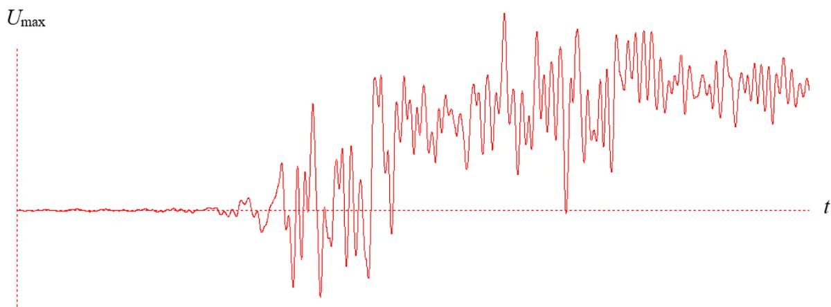
Рис. 3.27. Перемещение на четвертом этаже ( $U_{\max}=0.167$  м) при использовании вязкоупругопластического сейсмоизолятора между нижним и верхним фундаментами
