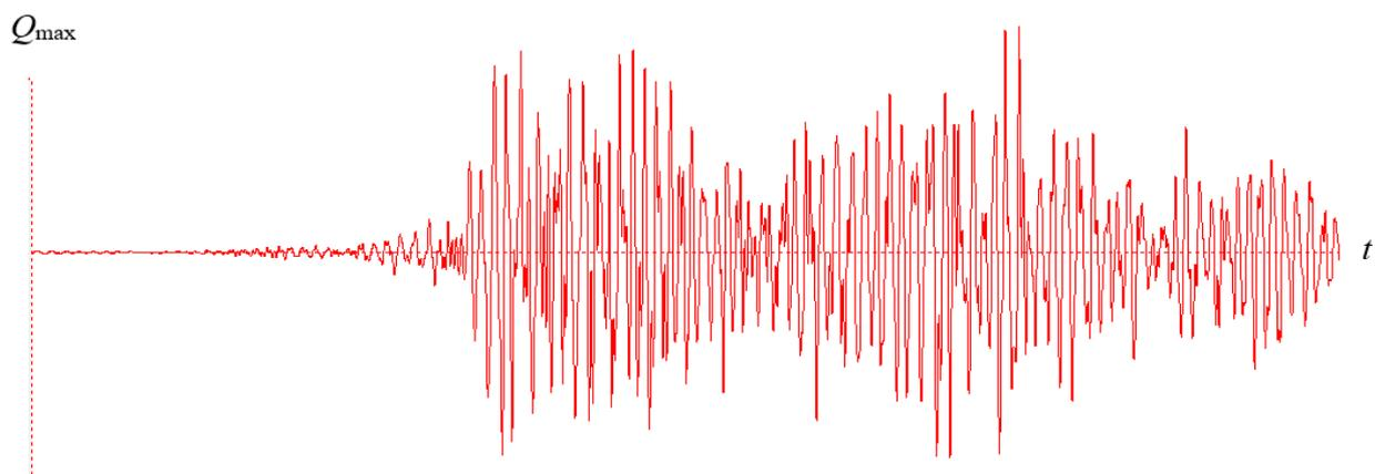
Рис. 3.30. Перерезывающая сила на третьем этаже ( $Q_{\max}=1900000$  Н) при использовании вязкоупругопластического сейсмоизолятора между нижним и верхним фундаментами
