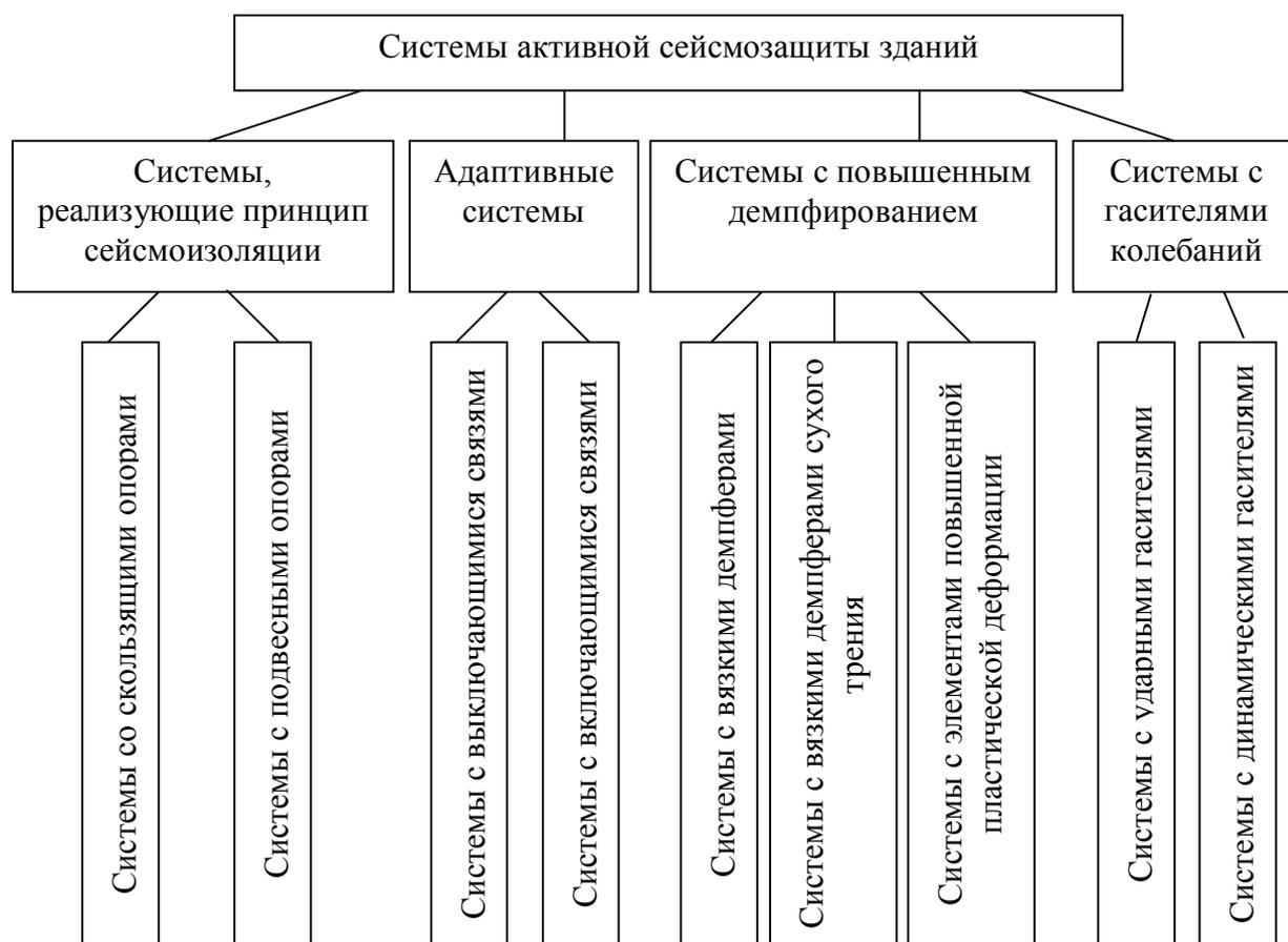
Рис. 2.1. Классификация систем активной сейсмозащиты
