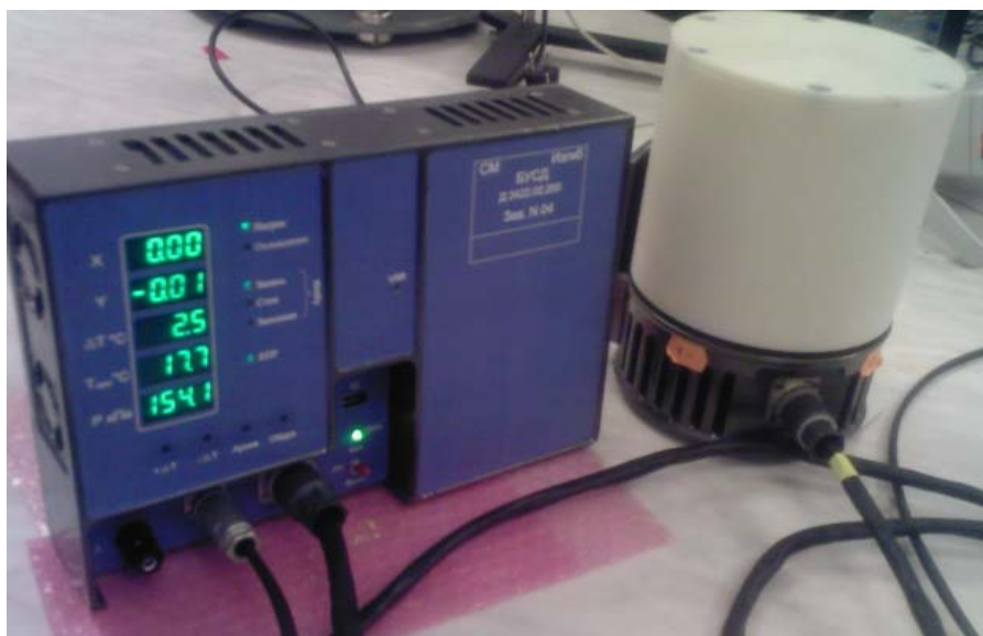
Прибор «Дакон-М» (*) . Слева - электронно-цифровой блок, справа - термостат
