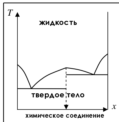
Рис. 19. Дистектическая диаграмма состояния при образовании химического соединения
