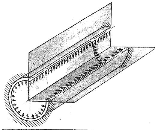
Изображение деформации цилиндрической оболочки, жестко закрепленной в торцах и нагруженной равномерно распределенным давлением изнутри. Если эта оболочка достаточно тонкая, то почти по всей длине ее деформация сводится к равномерному увеличению диаметра. И лишь в пограничных слоях у торцов проявляются локализованные краевые эффекты (на рисунке заражены), определяющие результатирующую форму деформированной оболочки (цветная линия).
