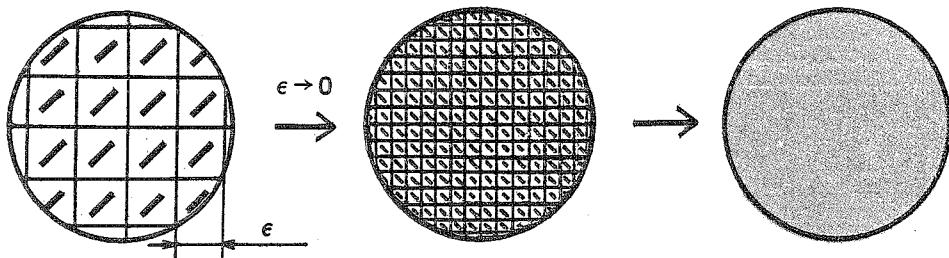
Схема, иллюстрирующая применение метода усреднения при исследовании композитных (неоднородных) материалов. Отвлекаясь от микроструктуры неоднородностей и устремляя их характерный размер  $\epsilon$  к нулю, производят усреднение и заменяют неоднородный материал с периодической структурой однородным с некоторыми средними [приведенными] параметрами. В то же время асимптотический подход позволяет оценить и микродеформации [напряжения] в композите, обусловленные периодичностью его структуры.
